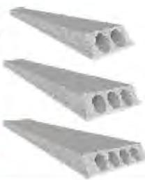
**Płyty stropowe kanałowe** tworzą system prefabrykowanych płyt stropowych o szerokości 60, 90, 120, 150 cm, wysokości 24 cm i maksymalnej długości 720 cm. Płyty posiadają w zależności od szerokości 2, 3, 4 lub 6 podłużnych kanałów o średnicy 17,8 cm. Przeznaczone są do stosowania w stropach budynków różnorodnej konstrukcji i funkcji o obciążeniu charakterystycznym ponad ciężar własny 4,5 kN/m<sup>2</sup>
