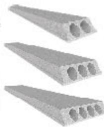
Raty stropowe kanałowe tworzą system prefabrykowanych płyt stropowych o szerokości 60, 90, 120, 150 cm, wysokości 24 cm i maksymalnej długości 720 cm. Płyty posiadają w zależności od szerokości 2, 3, 4 lub 6 podłużnych kanałów o średnicy 17,8 cm. Przeznaczone są do stosowania w stropach budynków różnorodnej konstrukcji i funkcji o obciążeniu charakterystycznym ponad ciężar własny 45 kN/m<sup>2</sup>.
