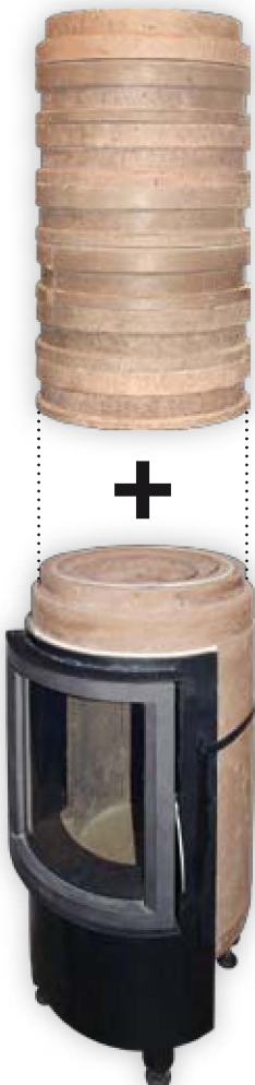
Akumulacyjne palenisko z akumulacyjnymi krążkami CMA-R (350-500 kg)
