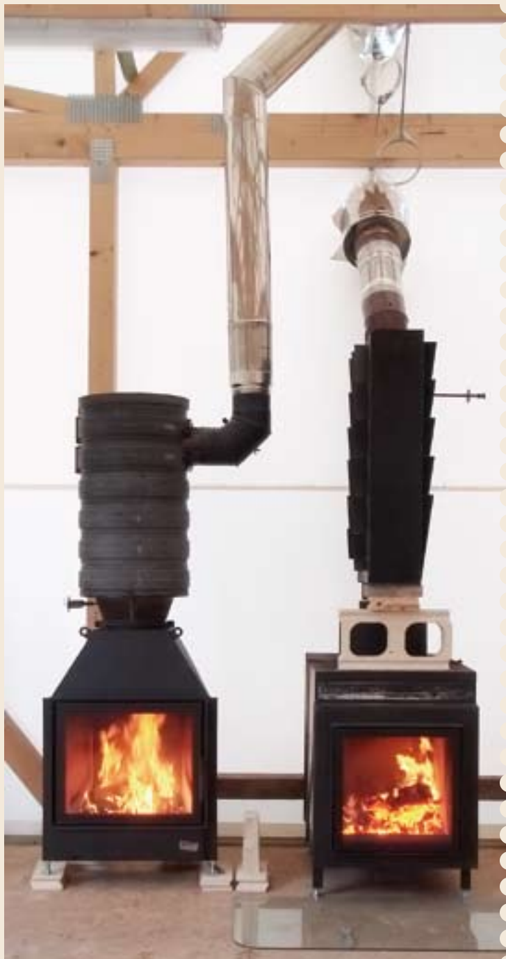
Stanowiska badawcze w Łaziskach koło Wągrowca. Mając możliwość jednoczesnego badania 4–6 urządzeń, zdobyliśmy sporą wiedzę na ich temat. Na zdjęciu Mini S z Helixem firmy Spartherm oraz palenisko zdunskie z wymiennikiem stalowym
