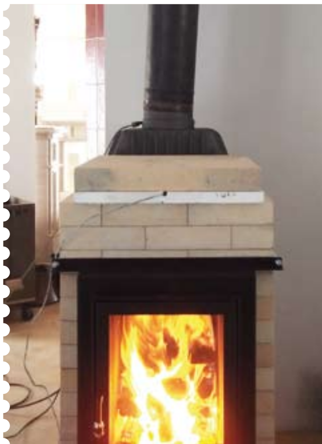
Stanowisko badawcze pieca (paleńsko) ceramicznego. Dwie sondy kontrolują dopalanie gazów po podaniu powietrza wtórnego oraz wartość, jaką mają gazy opuszczające paleńsko
